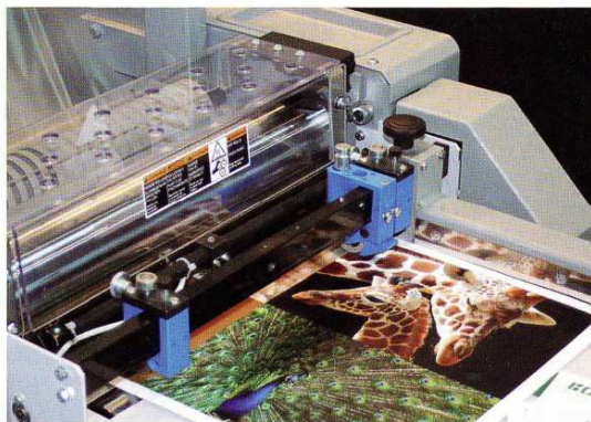
Nakládání je u nového laminátoru manuální s možností nakládání produkce digitálního tisku
